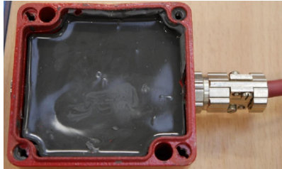
Abbildung 5-4-2: Anschlusskasten mit angelötetem Anschlusskabel
