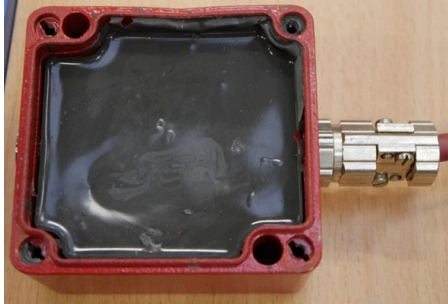
Abbildung 5-3-2: Anschlusskasten mit angelötetem Anschlusskabel
