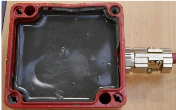
Abbildung 5.3.2: Anschlusskasten mit angelötetem Anschlusskabel
